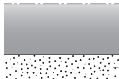
Sintereisen, mit Öl getränkt Sinter iron, impregnated with oil
